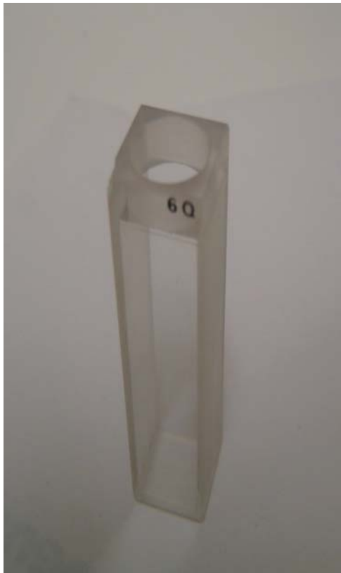
Sliki 6,7: levo navadna spektrofotometrična kiveta, V = 4 \text{ mL} , optična pot 10 \text{ mm} ; desno pretočna kiveta št., V \approx 0,5 \text{ mL} , uporabljena optična pot 4 \text{ mm}
