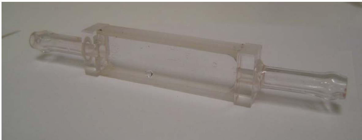
Slika 8: pretočna kiveta št.2; V \approx 1,1 \text{ mL} , optična pot 3 \text{ mm}
