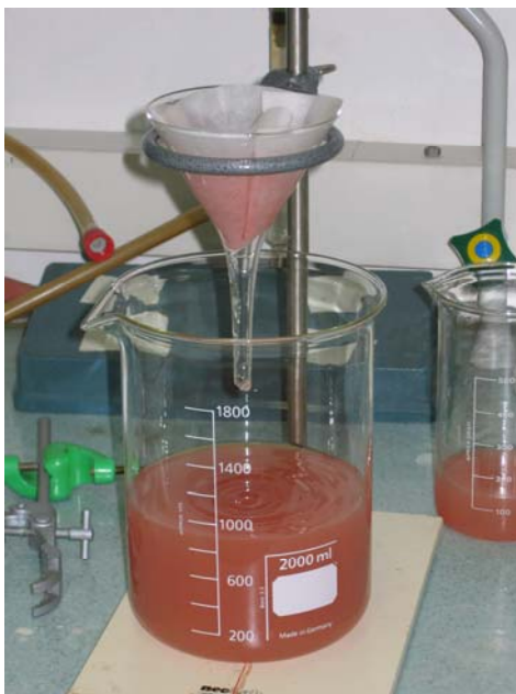
Slika 3: filtriranje surove vode preko filtra črni trak
