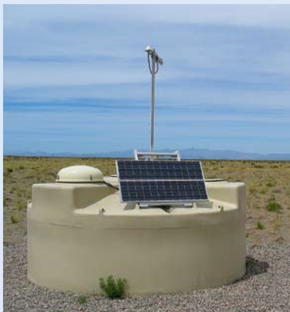
Eden izmed 1600 talnih detektorjev v argentinski Pampi Amarilli. Od zunanje opreme sta vidna solarni panel in komunikacijska antena.
