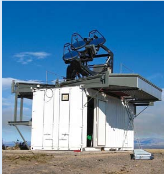
Lidar v bližini fluorescenčnega detektorja Los Leones. Nad kontrolnim prostorom je nameščena zložljiva streha, ki podnevi varuje gibljiv laserski izvor in tri zbiralna ogledala.
