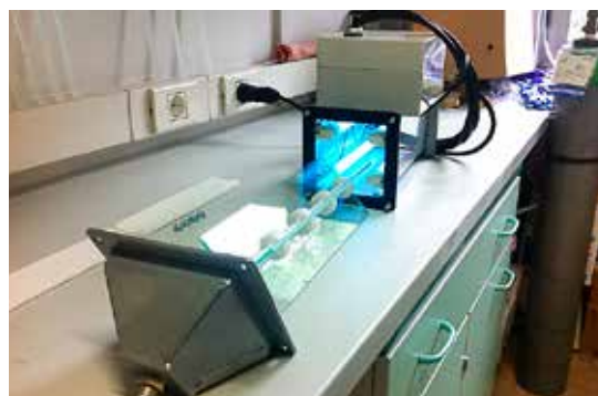
Skica in fotografija novega pilotnega fotoreaktorja za čiščenje zraka.
