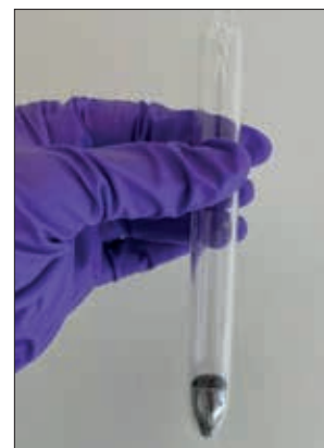
Sintetiziran visoko-kakovosten monokristal \text{Bi}_{2,2}\text{Mn}_{0,9}\text{Se}_{4,2} pripravljen po Bridgmanovi metodi.
