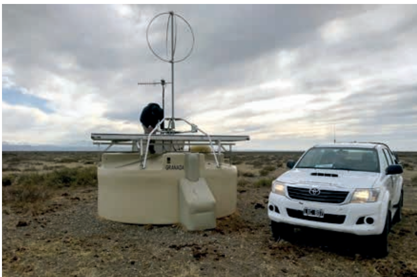
Zaključna dela pri nadgradnji sklopov talnih detektorjev observatorija Pierre Auger s scintilatorji za identifikacijo mionov in antenami za meritve elektromagnetne komponente plazov.
