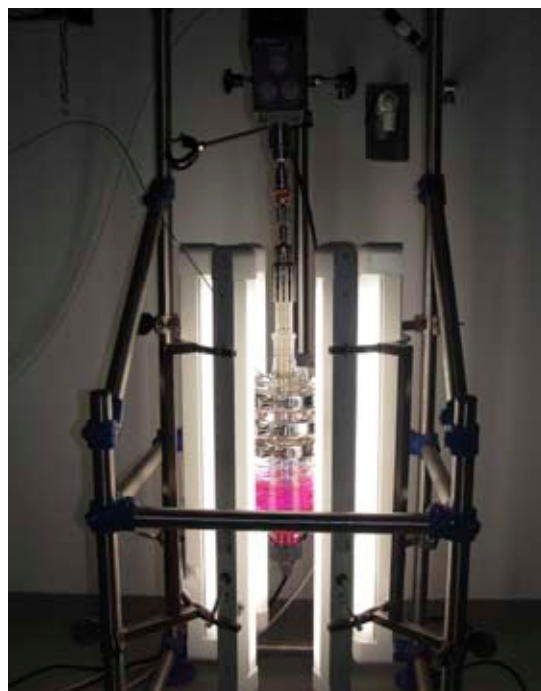
Slika 1: Reaktor za fotokemijsko cepitev vode in pridobivanje vodika. (foto: Urša Pirnat)
